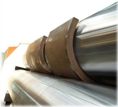
Roll diam : 460 mm => part diam : 496 mm
