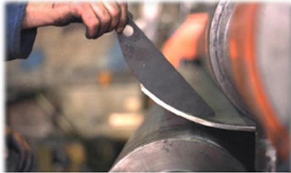
Croirage avec 3 rouleaux / Pre-bending with 3 rolls / Anbiegen mit 3 Walzen
