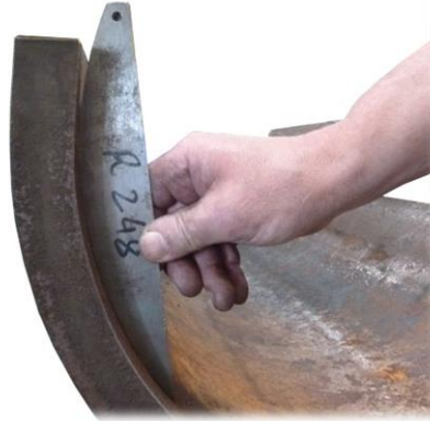
Roll diam : 460 mm => part diam : 496 mm
