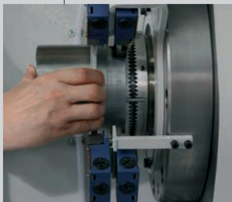
Particolare regolazione camme Cams setting detail
