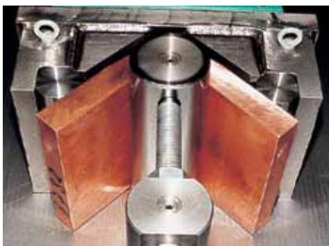
78 Curvado pletinas de gran espesor Curvatura de chapa de grande espessura
