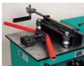
242 Curvado de tubos Curvatura de tubos
