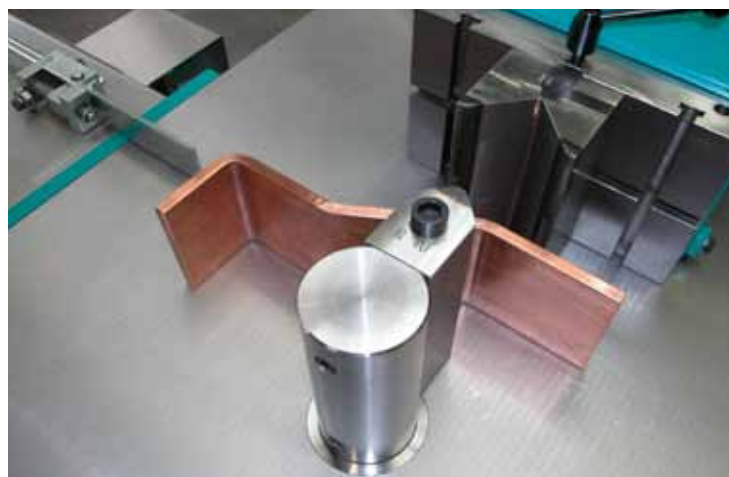
142 Curvado con punzón standard y programación rápida. Curvatura com o punção standard V e programação rápida.
