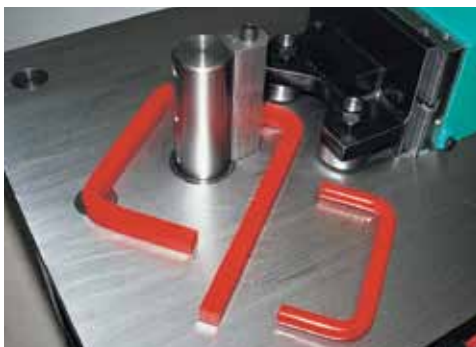
47 Rodillos V-Block para redondos, cuadrados y rectangulos Bloco em V de rolos para redondos, quad e rados
