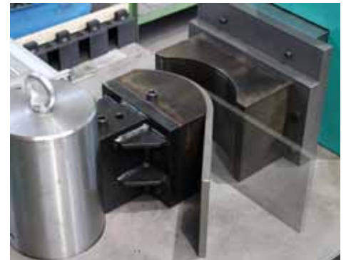
43 Curvado con utillajes de conformado Curvatura com ferramentas de conformação
