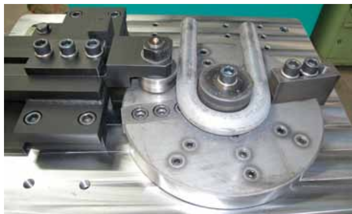
173 Base Standard con rodillo curvado, conductor y pestillo de curvado Base standard com roda de curvatura, condutor e parafuso de curvatura
