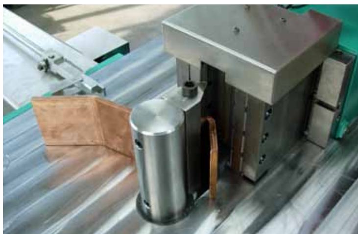
151 Matriz con sistema de medida integrado para re-curvado automático. Matriz com sistema de medição integrado para re-curvatura automática.
