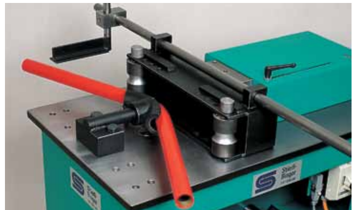
92 Curvado de tubos Curvatura de tubos
