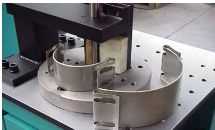
163 Curvado perfiles altos y espesor sutil. Curvatura de perfis altos e espessuras finas
