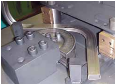
44 Curvado de tubos rectangulares Curvatura de tubos retangulares
