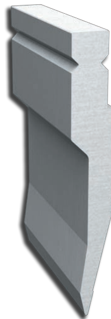
UST 86° R1,0/S altezza-height 220 mm angolo-degree 86° raggio-radius 1,0 mm 42CrMo4 rettificato-grinding temprato ind.-induction hardened HRC 52/58 lunghezze-lengths 500 mm - fraz A-B-C-L
