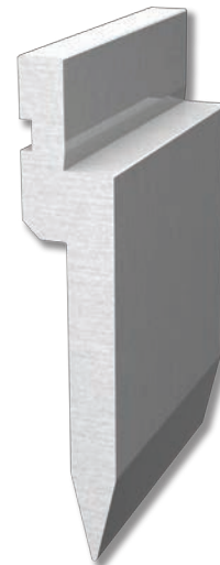
US 137/26° R0,8 altezza-height 117,00 mm angolo-degree 26° raggio-radius 0,8 mm 42CrMo4 rettificato-grinding temprato ind.-induction hardened HRC 52/58 lunghezze-lengths 835 mm - 415 mm - fraz
