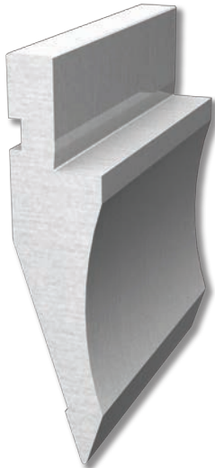
US 111/35° R0,8 altezza-height 65,00 mm angolo-degree 35° raggio-radius 0,8 mm C45 rettificato-grinding temprato ind.-induction hardened HRC 52/58 lunghezze-lengths 835 mm - 415 mm - fraz
