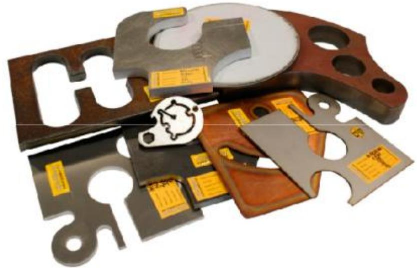
*Corte por plasma indirecto* (“*Tecnología HotWire*”) permite cortar además materiales no conductores
