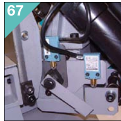
67 000910 RTD RTP Synchronisateur table à rouleaux / archet. Sincronizador rulinas / movimiento arco
