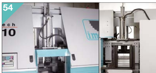
54 AUTOMATICQUES SERIE MAXI - AUTOMATICAS MAXI SERIES Dispositif hydraulique coupe en paquet. Aparato hydraulico para corte a paquete.
